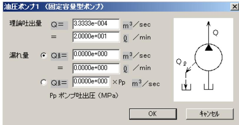
図3 固定容量形ポンプのパラメータ設定画面
